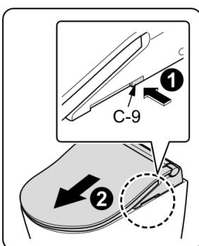
Nemontujte a nedemontujte řídicí jednotku, když je zapnuto napájení nebo do ní teče voda.
