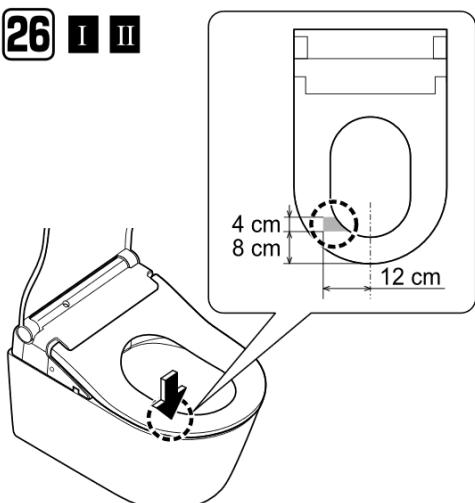
**1** Dlaní nebo předloktím se dotkněte oblasti vyznačené přerušovanou čárou (oblast snímače sedátka).
