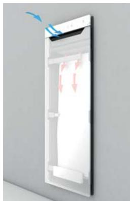
Vzduch z místnosti je nasáván otvorem pod skleněným krytem topným ventilátorem. Ohřátý, zhora proudící vzduch v krátkém čase nahřívá a suší ručníky.
