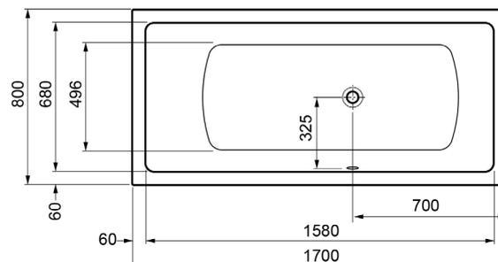
Badewanne aus gegossenem Sanitäracryl, 5 mm, 2-fach verstärkt, mit durchgängigem Bodenbrett und Wannrandverstärkung. Einbau durch Unter- bzw. Abmauerung, WannenfüÙe oder Wannenträger, gefertigt nach DIN EN 198.
